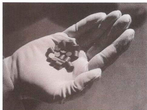
Таблетки оксида урана, используемые в ядерных реакторах.
