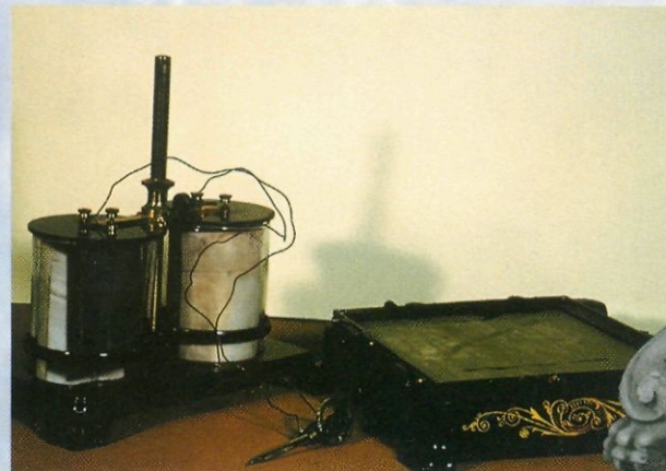
▲ «Электрическое перо» автоматически делает большое количество копий с оригинала — текста, карты или чертежа.
