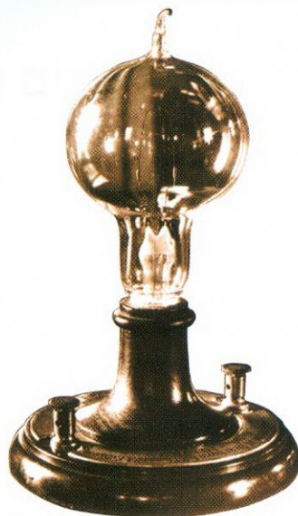
▲ Работа над электрической лампой накаливания была завершена 21 октября 1879 года. Волокна этой лампы хватало на 100 часов работы, тогда как у ранних ламп это время не превышало 10 часов.
