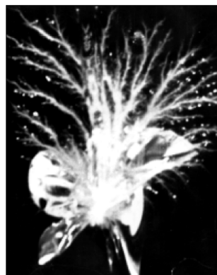
Рис. 10. Фигура Лихтенберга в стекле, облученном протонами с энергией 100 МэВ
