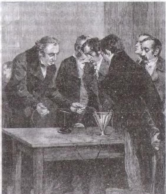
Эрстед демонстрирует отклонение магнитной стрелки под действием электрического тока
