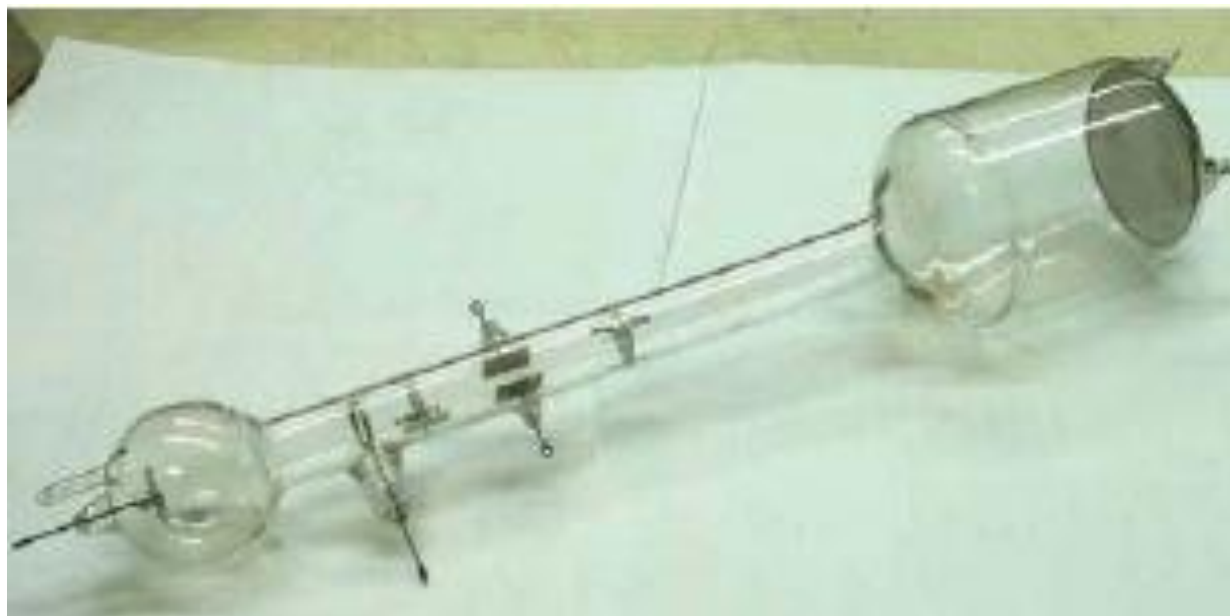
Так называемая «трубка Розинга» (реконструкция)
