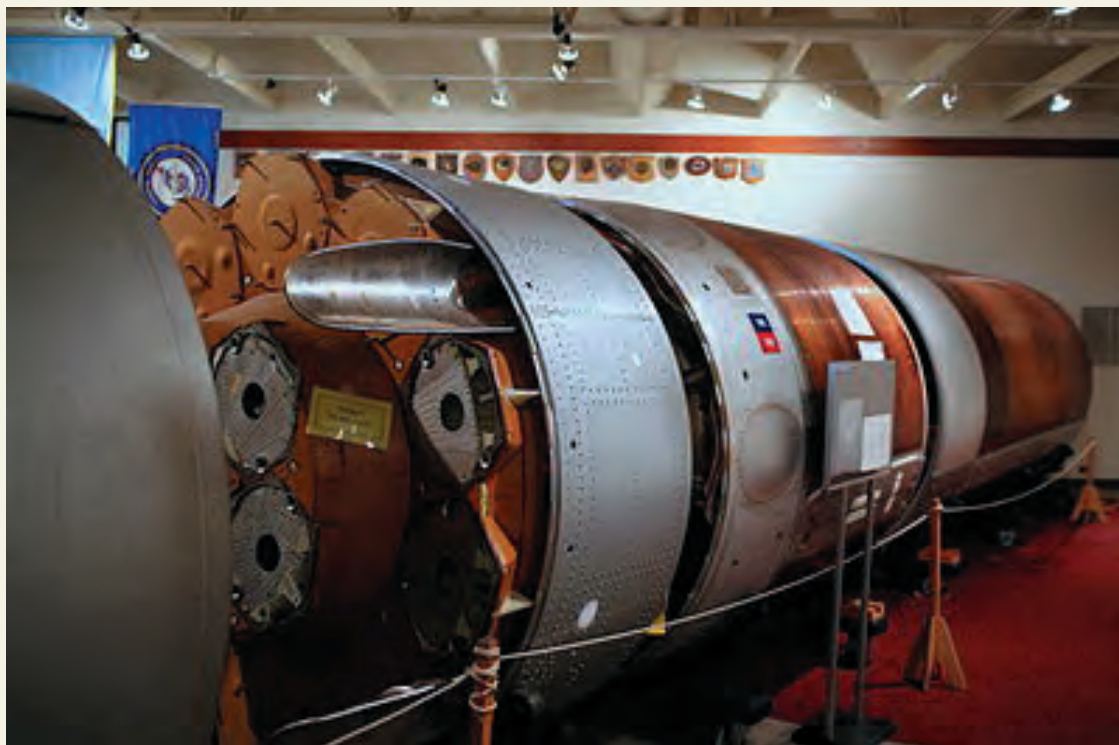
МБР «Poseidon» («Посейдон»). Максимальная дальность – 4600 км, забрасываемый вес – 2000 кг, точность (КВО) – 800 м, тип ГЧ – РГЧ ИН, 10, 50 кт (6х50), стартовая масса – 29,5 т, длина – 10,36 м, диаметр – 1,88 м, количество ступеней – 2
