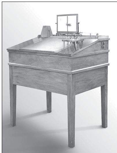
В 1878 г. была создана точная копия приёмо-передающего комплекта в составе двух одинаковых комплектов пишущих телеграфов конструкции Б.С. Якоби
