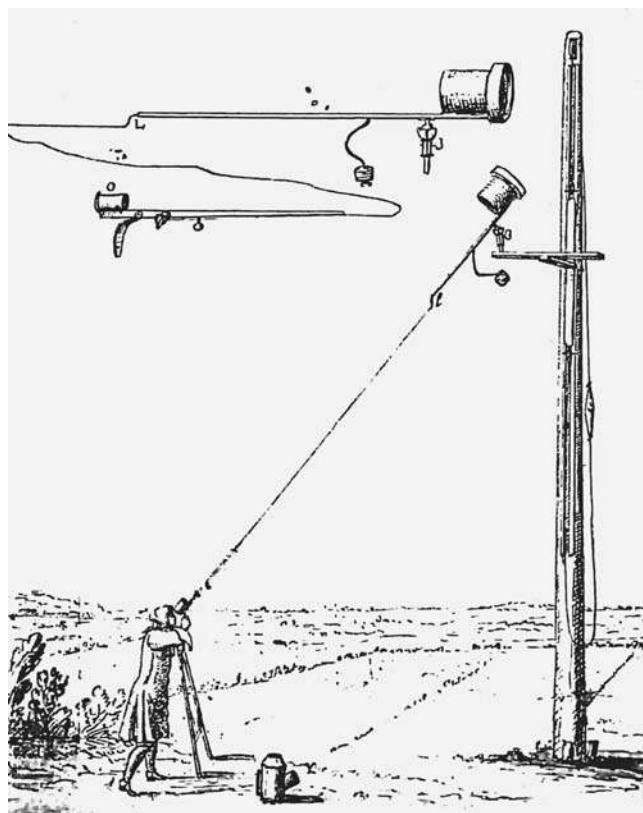
Воздушный телескоп Гюйгена имел большое фокусное расстояние, которое достигалось разделением объектива и окуляра и соединением их с помощью каната
