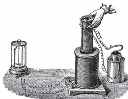
*Аппарат Фарадея демонстрирует электромагнитную индукцию между двумя катушками провода. Жидкостная батарея справа обеспечивает ток. Малая катушка входит и выходит из большой катушки, чтобы создать в большой катушке ток. Наличие тока показывает гальванометр, расположенный слева.*
