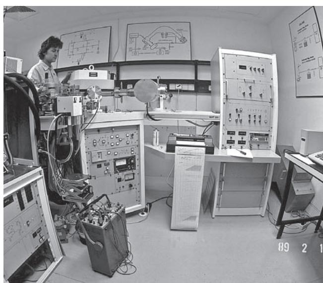
*Масс-спектрометр использовался для оценки стабильных изотопов углерода и кислорода*
