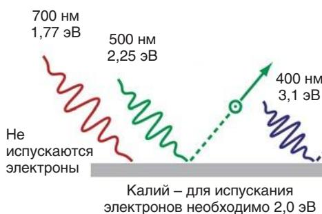
*Фотоны, попадающие на поверхность, смогут выбить электроны только в том случае, если они обладают достаточной энергией. Красный свет не дает тока, а синий или зеленый дают*
