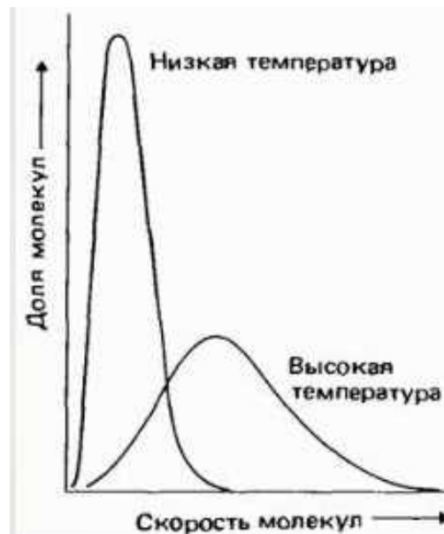
Рис. 123. Функции плотности распределения молекул в зависимости от скорости при высоких и низких температурах
