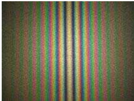
Рис. 110. Интерференционная картина, полученная при помощи интерферометра зеркалами под углом немного отличающимся от перпендикулярности
