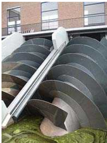
Рис. 7. Современные архимедовы винты, используемые для осушения пolders (низменный участок побережья) в Голландии (Интернет)
