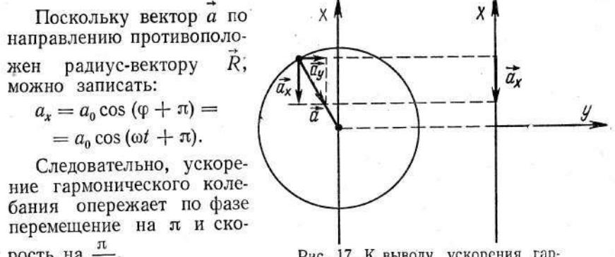
Рис. 17. К выводу ускорения гармонического колебания.
