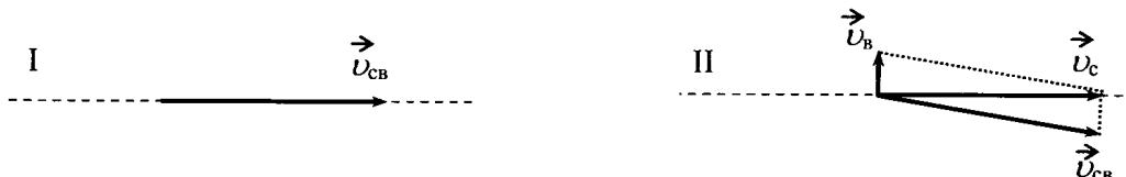
Закон сложения скоростей в векторном виде для перелета во время ветра:  $\vec{v}_c = \vec{v}_{\text{св}} + \vec{v}_B$ , где  $v_c$  — скорость самолета относительно Земли,  $v_B$  — скорость ветра.
