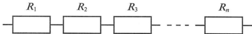
1. Сила тока во всех последовательно соединённых участках цепи одинакова:  $I_1 = I_2 = I_3 = \dots = I_n = \dots$
