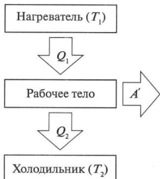
Максимальный КПД при заданных температурах нагревателя и холодильника имеет идеальная тепловая машина (машина Карно):
