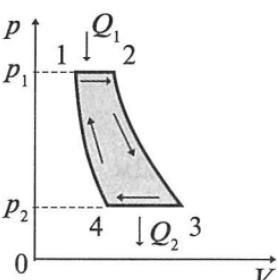
Суммарная работа за циклический процесс численно равна площади, ограниченной графиком процесса в координатах  $p$  —  $V$ .
