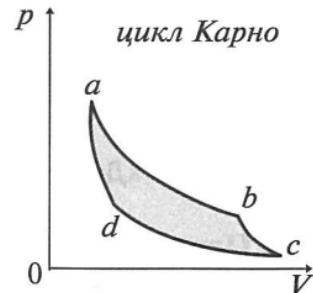
**КПД идеальной машины** определяется только значением температур нагревателя  $T_1$  и холодильника  $T_2$  и не зависит от устройства машины и типа рабочего тела:  $\eta_{\max} = \frac{T_1 - T_2}{T_1} \cdot 100\%$ .
