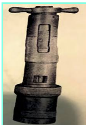
Прибор Ф.Е. Колясева для определения влажности почвы без взвешивания почвенных образцов
