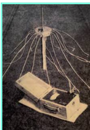
«Термопак» – термометр для измерения температуры поверхности почвы
